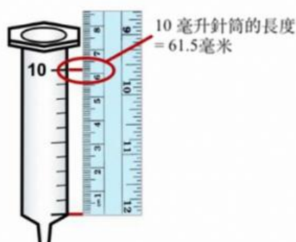
图 A.2 10 mL 标准注射器针筒示意图
